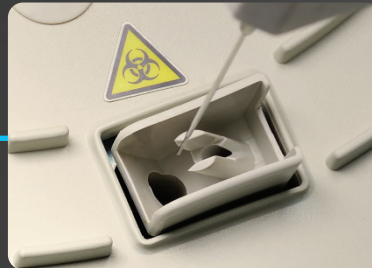
Nettoyage de la sonde cascade
